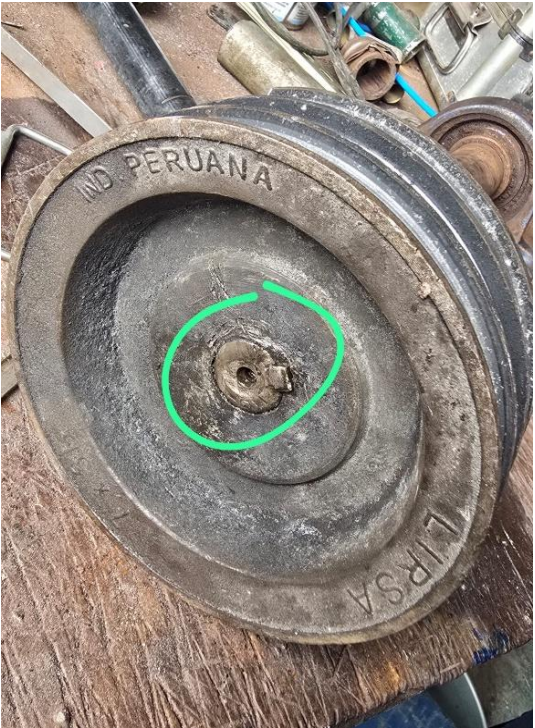
Polea modelo 7 X 3B / Marca LIRSA / para eje de 28.1mm
