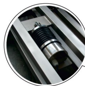
Celda de Carga totalmente protegida contra polvo y agua
