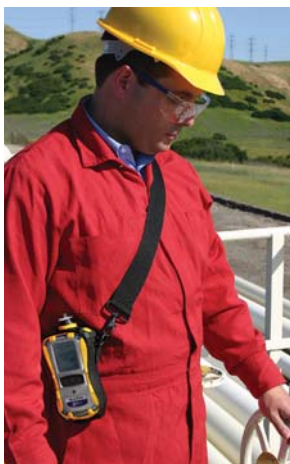
MultiRAE utilizado para controlar la exposición de los trabajadores en una refinería de petróleo
