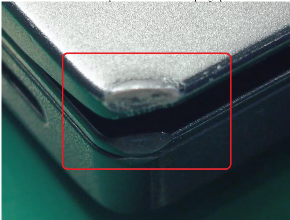
Cubierta de pantalla con deformado por golpe
