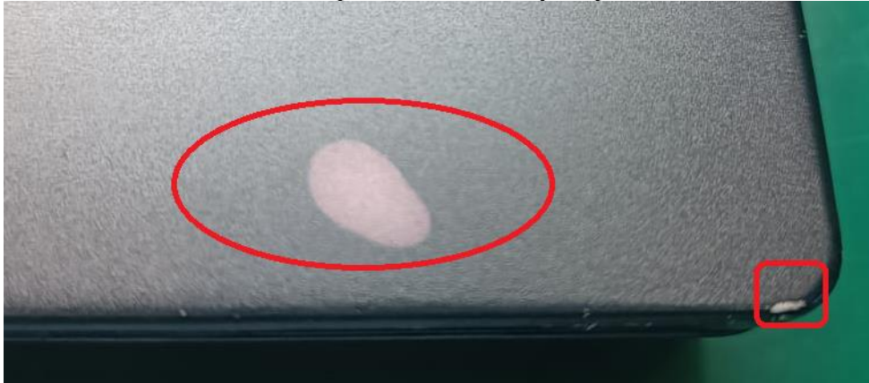
Cubierta de pantalla manchada y despintado
