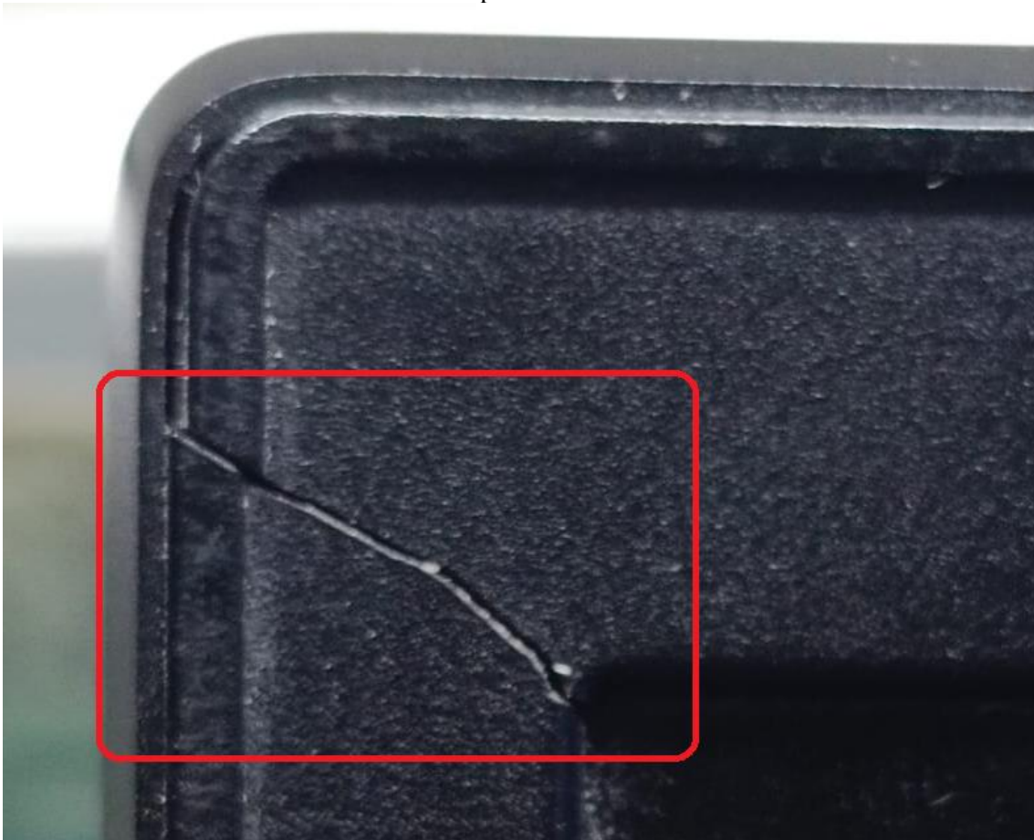
Cubierta de pantalla con deformado por golpe
