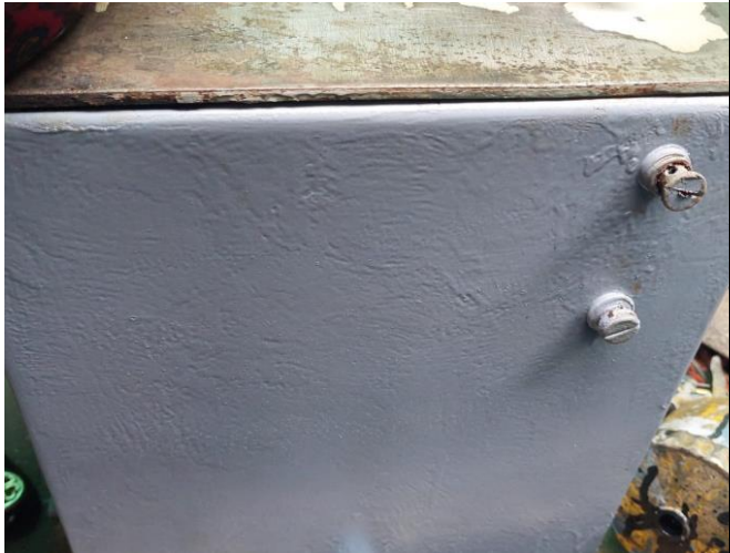
Unidad hidraulica N°07 no tiene visor de aceite
