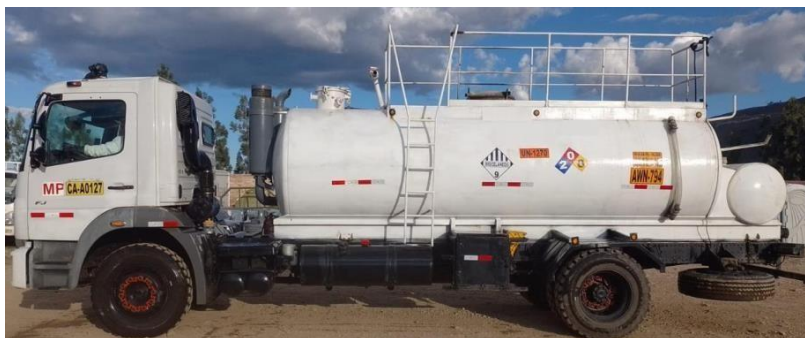
Cisterna de 10 m3
