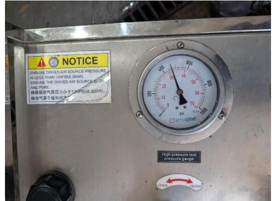
PRESION HIDRAULICA DE 450 P
