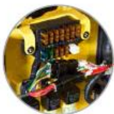
Caja de fusibles compacta para facilitar la inspección
