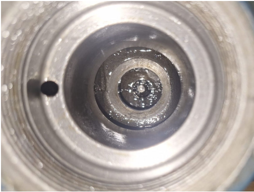
Fig. 7 - Limpieza y lubricación de asiento de teflón.
