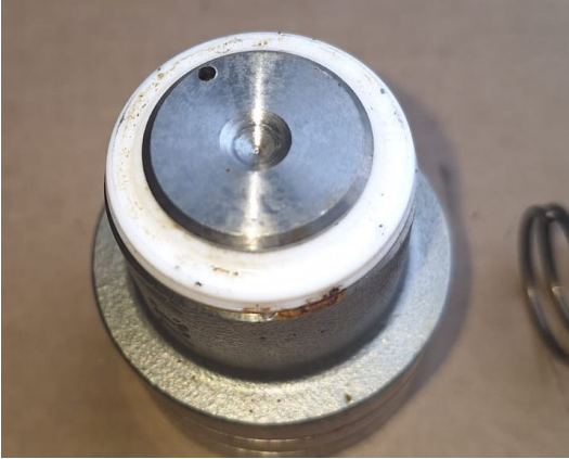
Fig. 3 - Suciedad encontrada en teflón.
