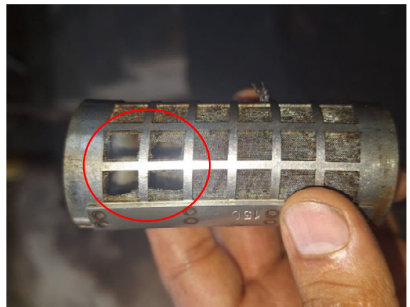
Fig. 2: Rotura principal en filtro.
