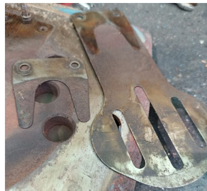
Válvulas de aspiración
