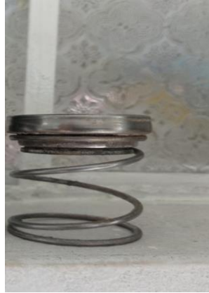
Figure 2 Sello mecánico reseco
