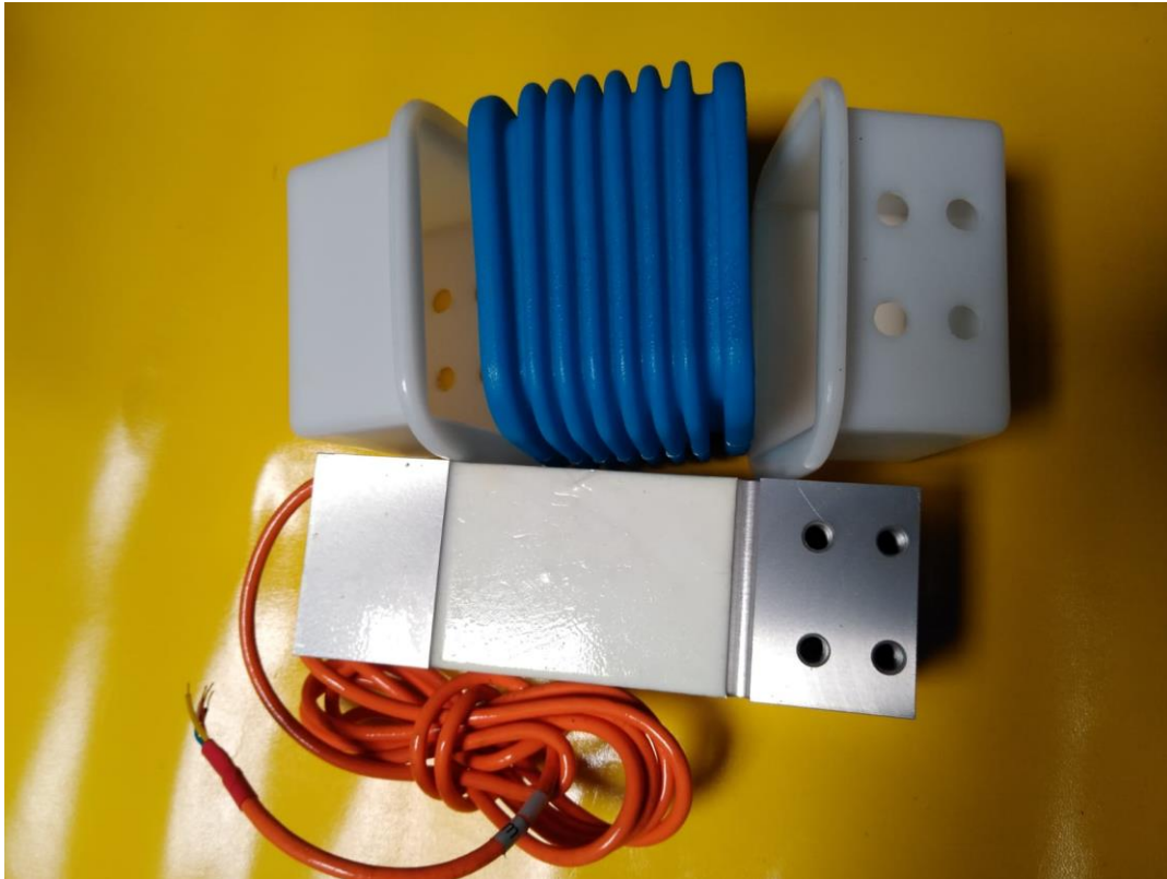
Celda de carga modelo UDA de capacidad 300kg con protector
