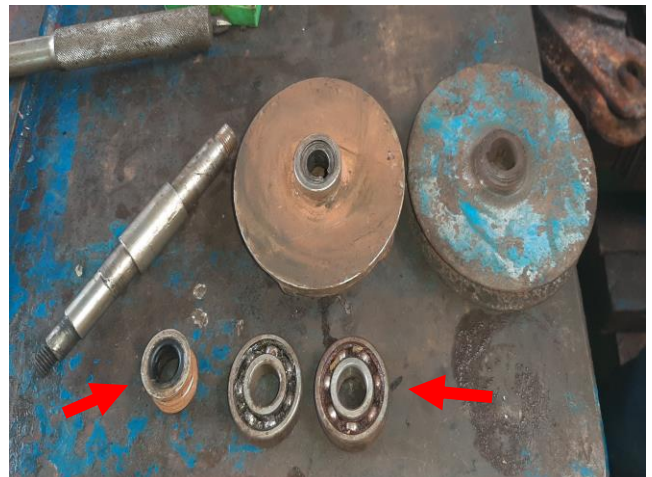
RODAMIENTOS Y SELLO MECÁNICO EN MAL ESTADO
